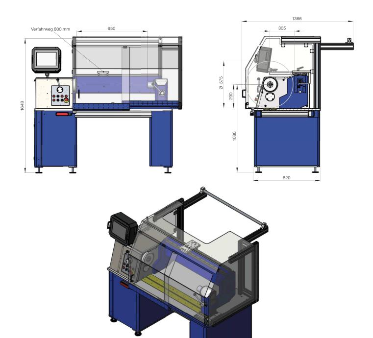
Drahtbereich0,01 - 6 mmVerlegebreite800 mmUmlaufdurchmesser575 mmmax. Vorschub99 mmAntriebsmotore2 ServosSpindelmotor bürstenlos3 kW5 kW verstärkte Version
