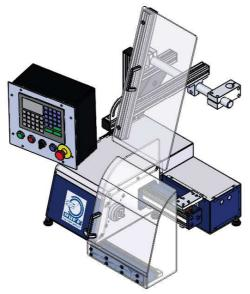
Drahtbereich0,01 - 0,8 mmVerlegebreite150 mmUmlaufdurchmesser220 mmmax. Vorschub99 mmAntriebsmotore2 ServosSpindelmotor bürstenlos400 WVerlegemotor bürstenlos100 W
